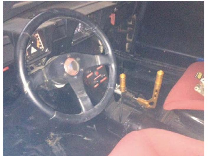
Motore Twin Spark, di derivazione Alfa Romeo 75, cambio corto e freno a mano idraulico.
